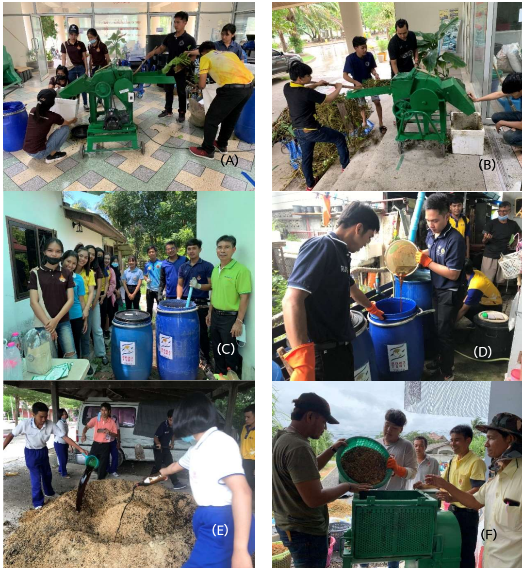
ภาพที่ 4.5 การบดย่อยวัสดุพืชที่เก็บจากพื้นที่เทศบาลเมืองเขารูปช้าง โดยใช้เครื่องบดเพื่อนำไปผลิต เชื้อจุลินทรีย์ประสิทธิภาพสูงและผลิตปุ๋ยชีวภาพแบบมีส่วนร่วม
